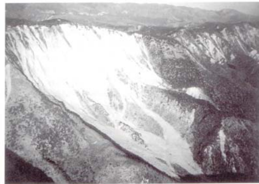
圖 3 山區淺層的滑動(主要為未固結沉積材料)
