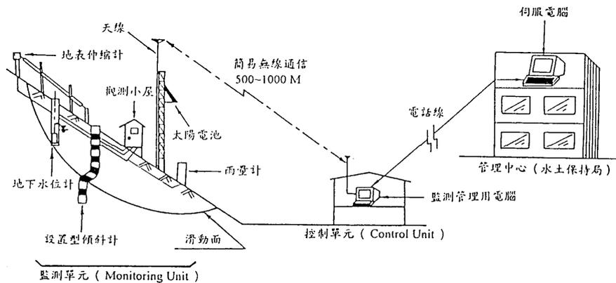
圖 2-2 梨山地滑區自動監測站系統架構示意圖
