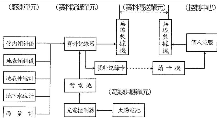
圖 2-1 梨山地滑區自動監測站組成示意圖
