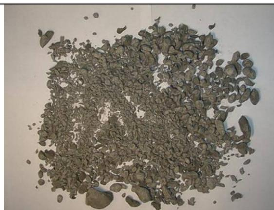
圖 17 消散耐久試驗二次循環後之岩樣
