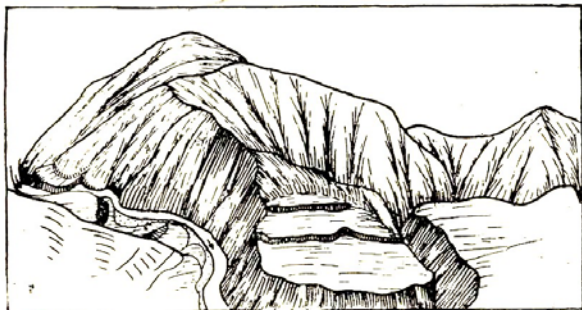
圖 3 由萬大東方 2 公里處南望，濁水溪之掘鑿曲流與滑走坡面上之段丘
