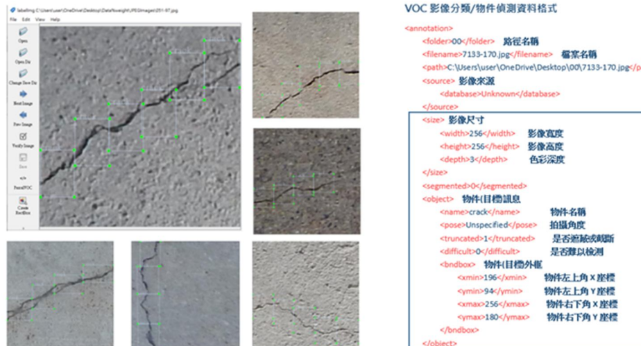
圖 3 (左) LabelIMG 影像標註圖；(右) VOC 格式標註檔案格式圖
